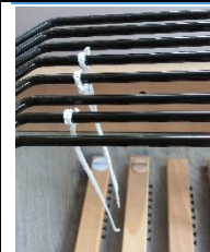
Koordjes op schachten 2, 4 en 5 (neergaande schachten) bij trapper 1
